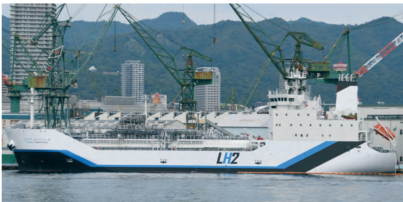
Suiso Frontier — первый в мире танкер для перевозки сжиженного водорода (LH 2 )
